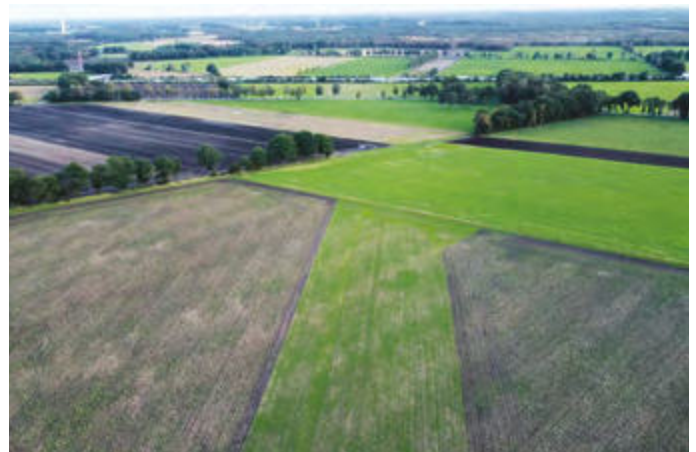
Durch die Vorbegrünung wird der spätere Trassenverlauf früh sichtbar. Baufeldgrenzen können so besser eingehalten werden und der Boden wird vor Erosion geschützt.
