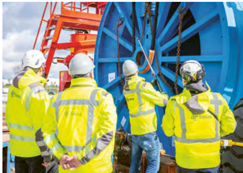
Nach der Produktion werden die Kabel auf riesige Trommeln gerollt und für den Transport vorbereitet.
