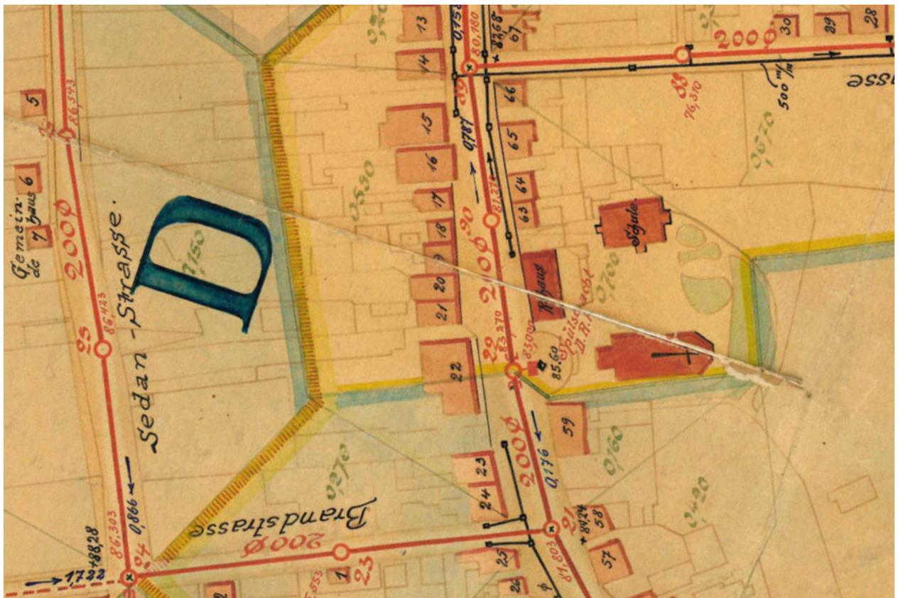
Abb. 2.2.11: Entwurf für ein Schmutzwasserkanalnetz, 1920, Ausschnitt (gedreht).
